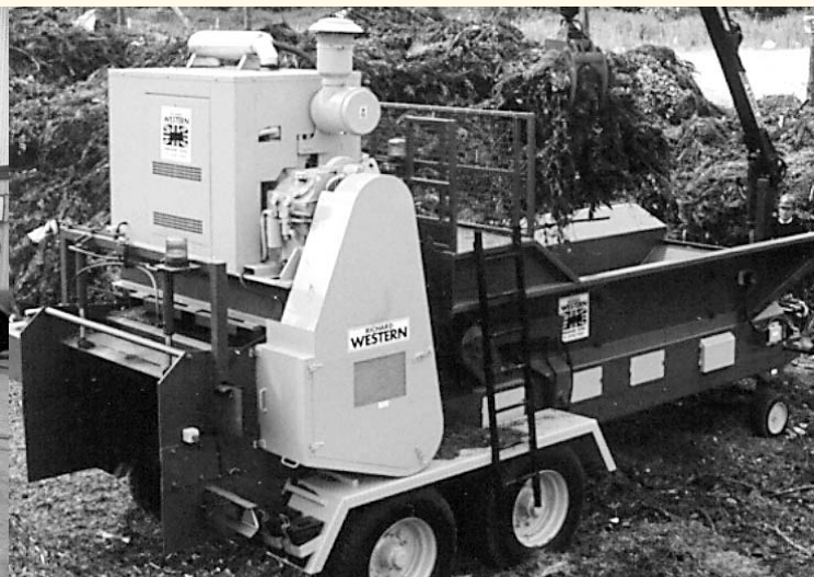
21 KPTO, Broyeur de végétaux, 350 kW à 1800 tr/min
