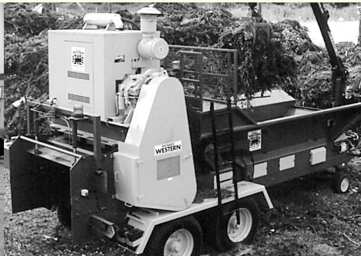
21 KPTO, per comando trucioliatore motore Diesel 350 kW a 1800 giri/min
