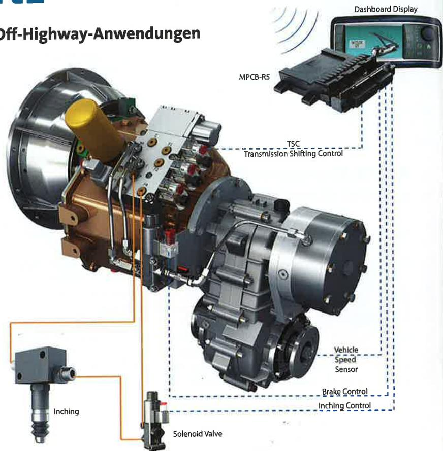
Der italienische Getriebespezialist Transfluid entwickelte mit dem Obstacle Proximity Control System (OPC) ein Assistenzsystem zur Förderung der Effizienz und Sicherheit von mobilen Maschinen. Das System wurde dabei speziell für die firmeneigenen Power-Shift-Familien Rangermatic und Revermatic entwickelt und ermöglicht Fahrzeugherstellern neue Anti-Kollisionsfunktionen.
