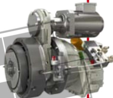
128 chilowatt (avalli) e garantisce un'accelerazione di 20 minuti in elettrico alla velocità di 7,6 nodi, quanto basta per ammazzare le emissioni sonore e navigare in rada, in acque lacustri e fluviali e nei parchi marini.
