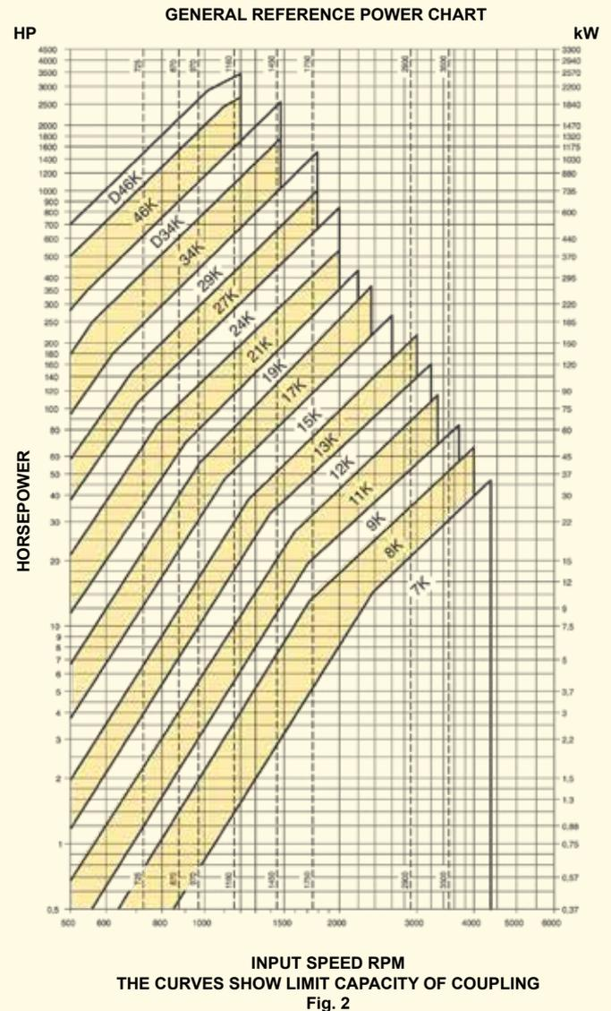
THE CURVES SHOW LIMIT CAPACITY OF COUPLING
